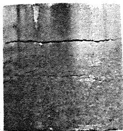
Fig. 8. Agrietamiento en una probeta cilíndrica comprimida a 1300 MPa.
