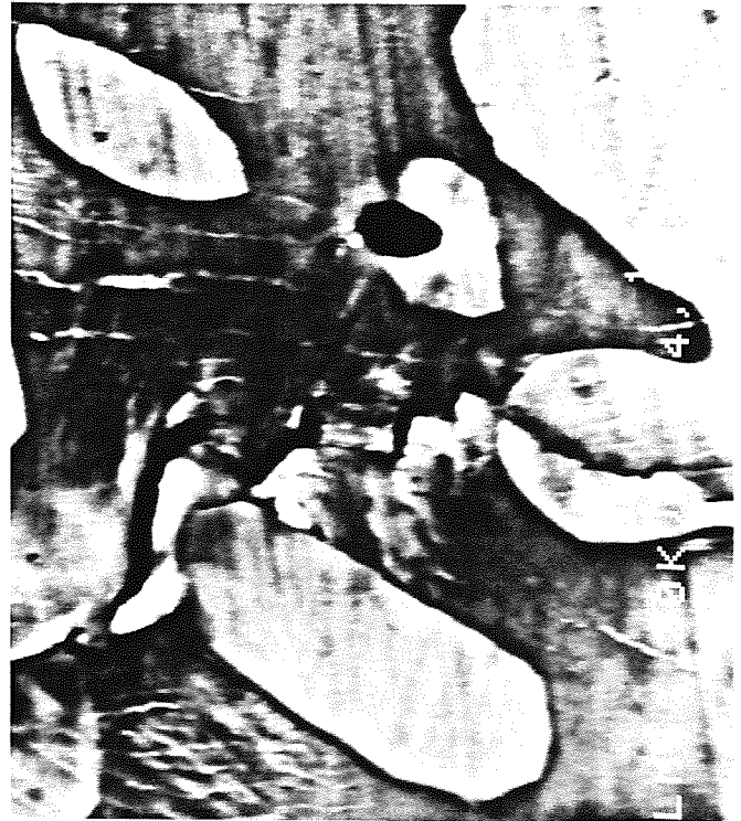
Fig. 6. Camino tortuoso de la grieta al propagarse por la fase ferrítica eludiendo los granos de austenita (acero sin envejecer).
