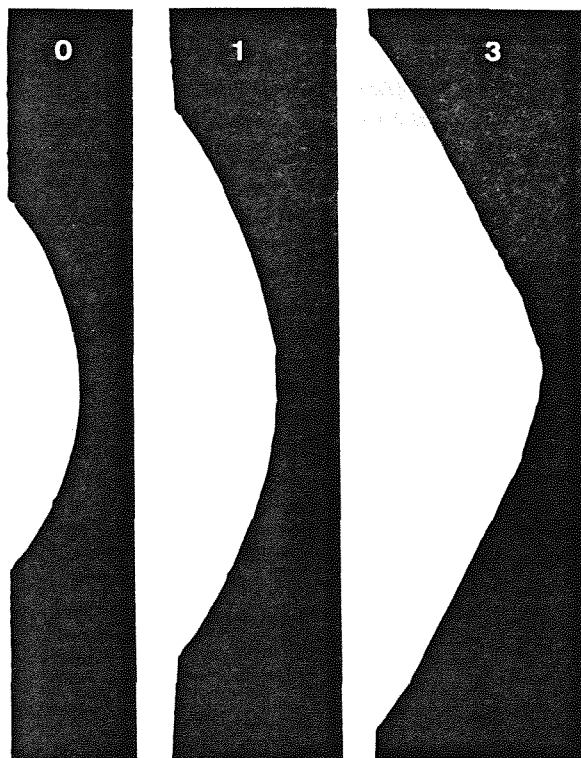
Fig. 5. Evolución del perfil de la entalla A para el acero 316L.
