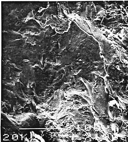
Fig. 7a. Micrografía por MEB del aspecto fractográfico completamente transgranular, y muy definido, en el material AR.
