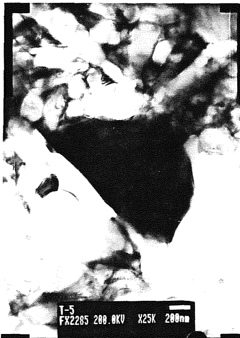
Figura 7. Microestructura (MET) mostrando Silicatos de Ytria cristalizados en el material sinterizado.
