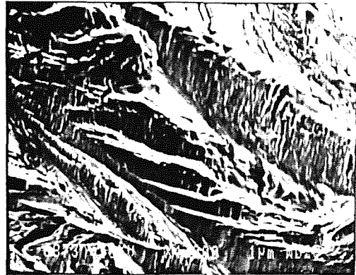
Fig. 9. Zona de rotura próxima al origen de un remache ensayado a fatiga (SEM, x 4000). Estriaciones frágiles y microgrietas asociadas.
