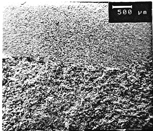
Figura 2. Superficie de fractura de la probeta ensayada a 1300 °C. Inferior de la foto zona a tracción durante el ensayo.
