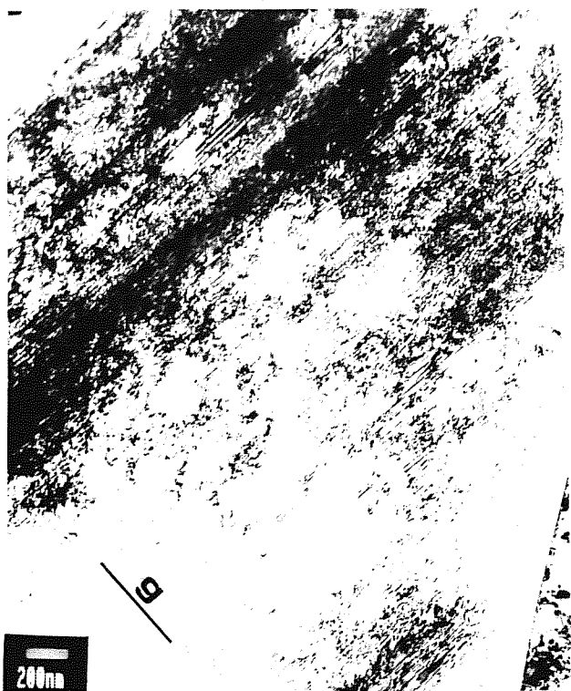
Fig. 6. Bandas de carácter planar en un grano austenítico. Muestra sin envejecer. g = [1\ 1\ 1]
