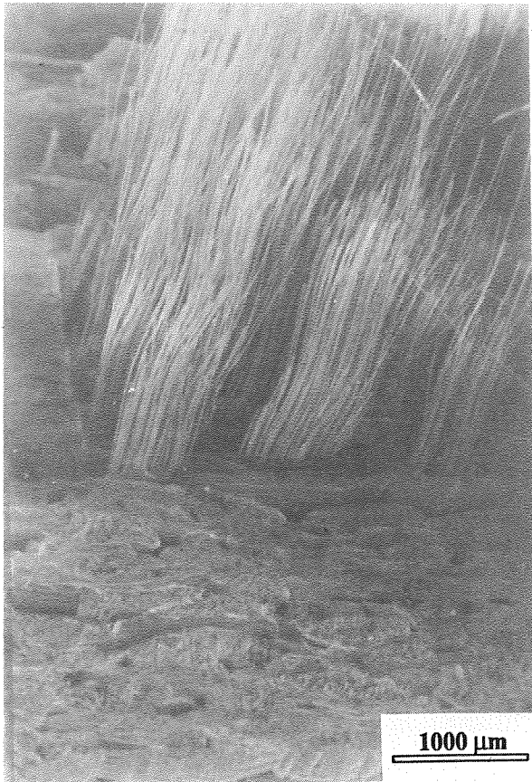
Fig. 8. Aspecto general de la superficie de fractura de una probeta ensayada a temperatura ambiente tras 100 horas de exposición a 1200°C. Junto a ella se encuentra una probeta ensayada a 1200°C después de 100 horas de exposición.
