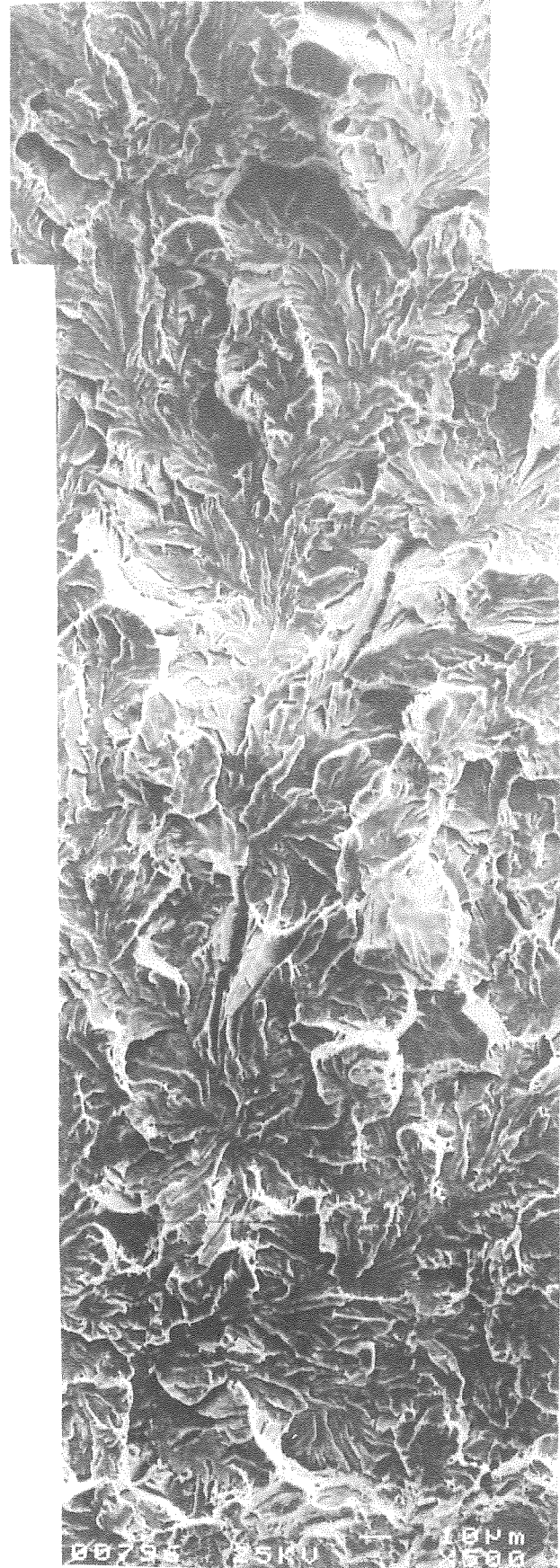
Fig. 1. Propagación de fractura por clivaje orientado
