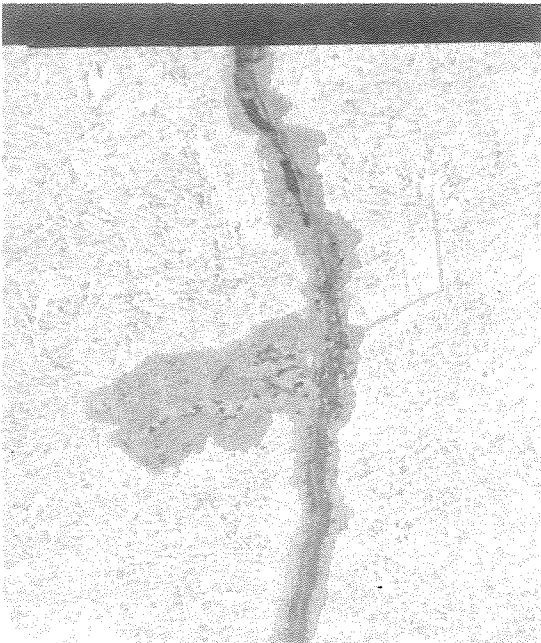
Fig. 4. Pequeñas ramificaciones y masas de óxidos formados en el interior de la grieta de un álabe. Estructura martensítica. Reactivo de Vilella. (200 X).
