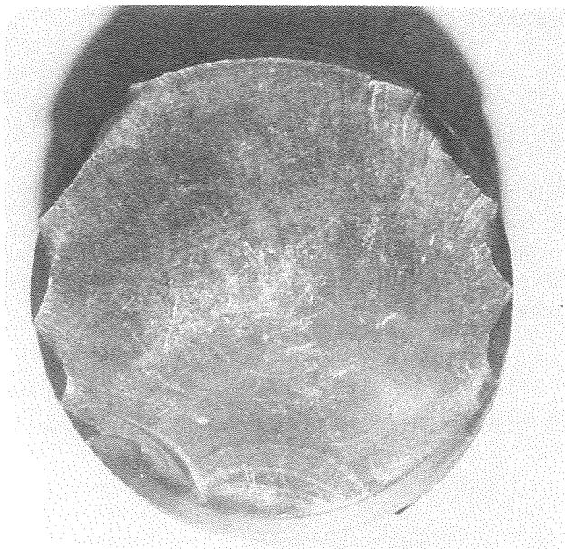
Fig. 8. Perno nº 3. Superficie de fractura en la parte inferior de la zona roscada. Marcas concoioidales que cubren toda la superficie y arrancan de la parte inferior del filete.
