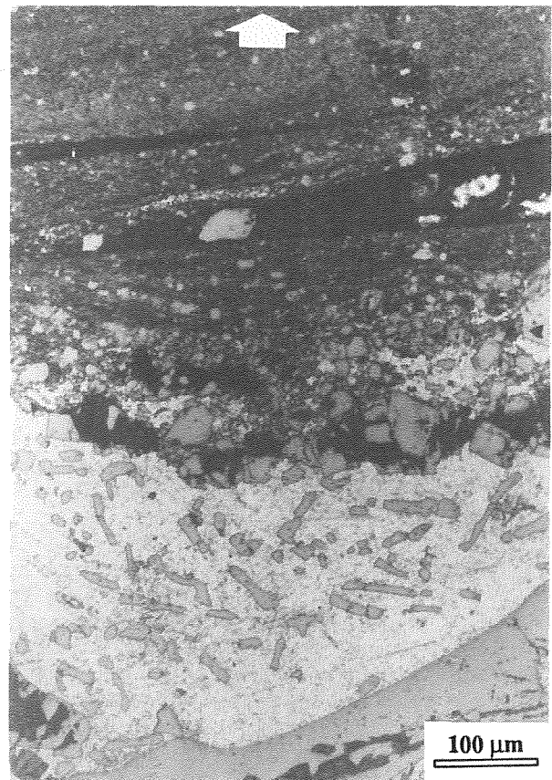
Fig. 8. Sección de una probeta de Al-20Si ensayada a 200 °C con un recorrido de 2000 m. La flecha indica la superficie de fricción. Se observa como los cristales de Si eutéctico están triturados, la matriz de aluminio deformada y aparecen grandes grietas.
