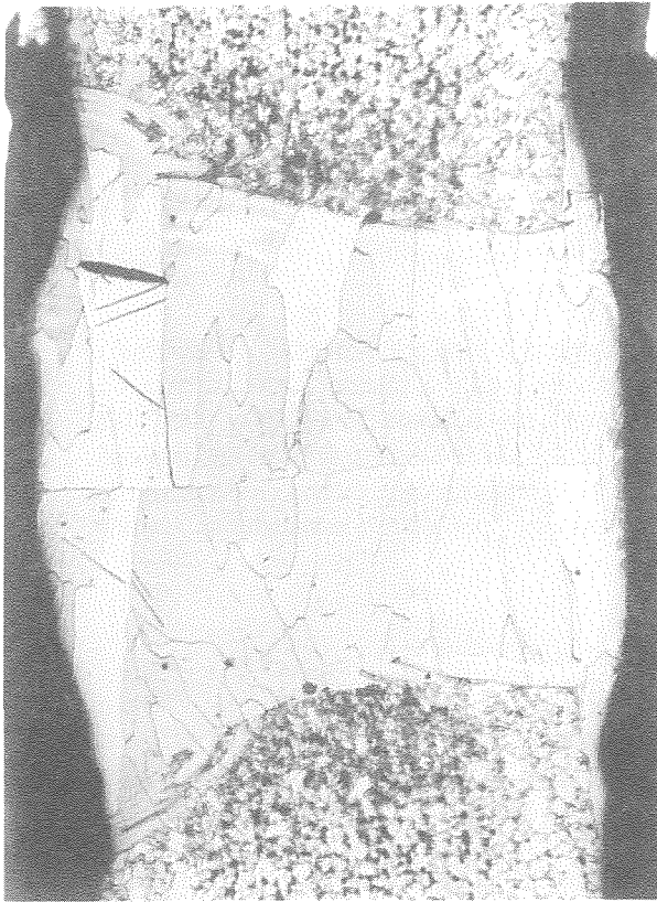
Fig. 1. Detalle de la zona fundida (X100)
