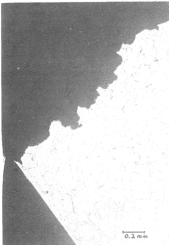
Fig. 5. Superficie de fractura. Probeta aleación Al2T. (x50).
