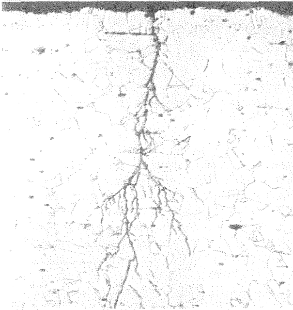
Fig. 8. 200x. Muestra 1. Corrosión Bajo Tensiones. La fisura se inicia en una zona "limpia" de la superficie externa. (Ataque agua regia glicerinada).
