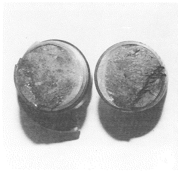
Fig. 10. Perno nº 4. Superficie de fractura en la zona roscada. Pequeño desarrollo de la zona rota por fatiga. Zona de desgarro muy amplia.
