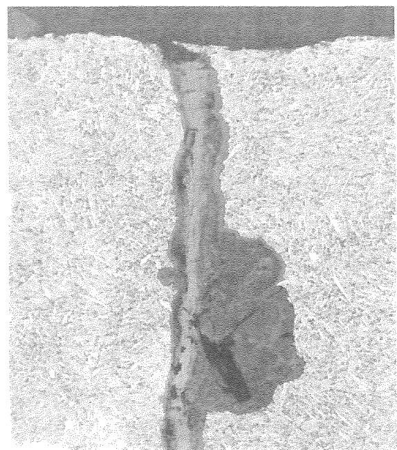
Fig. 3. Masas de óxido formados en el interior de la grieta de un álabe. Estructura martensítica. Ataque Reactivo de Vilella. (200 X)
