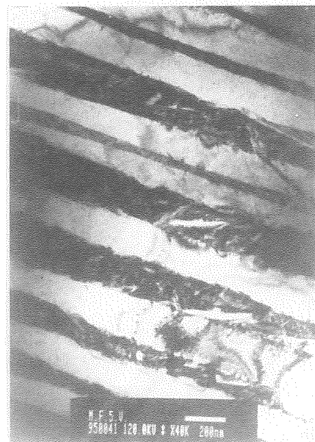
Fig. 6. Muestra deformada a fatiga ( 0.15 N_f ). Se observa la deformación de las placas de fase \alpha' de una forma alternada. Eje de zona: [0\bar{1}10] .
