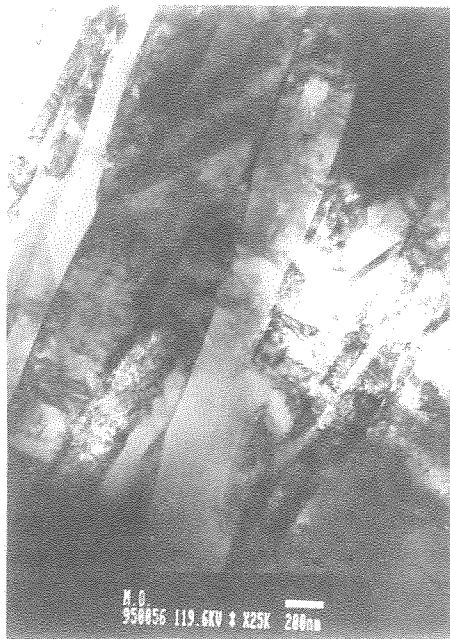
Fig. 5. Estructura martensítica constituida por placas alineadas de fase \alpha' . Eje de zona [0\bar{1}10] .
