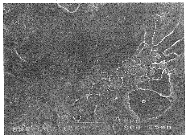
Fig. 9. Superficie de fractura de una probeta C.T. con un contenido del 40% de HPMA.
