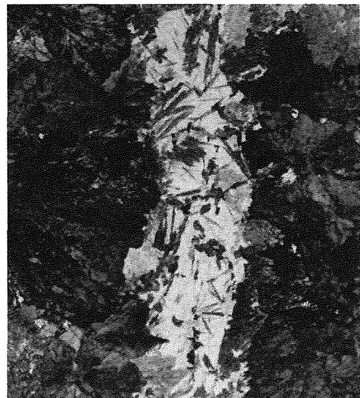
Fig.2. Microestructura del alma del carril N°3
