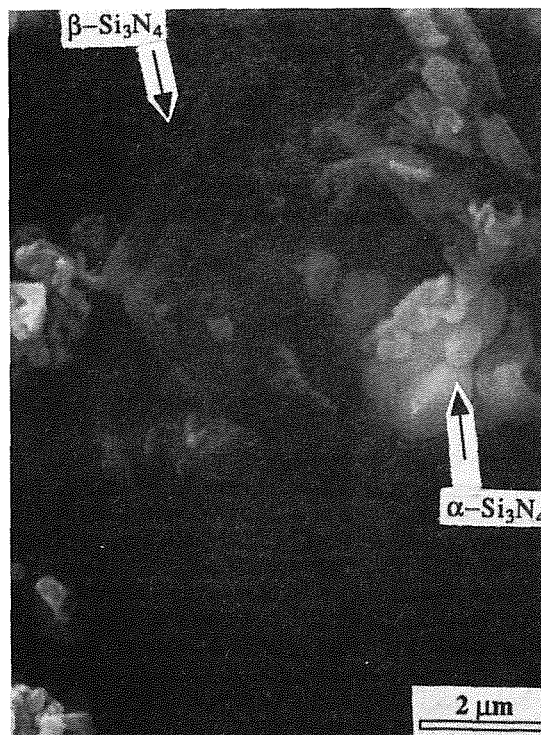
Fig. 2. Micrografía de los polvos \text{Si}_3\text{N}_4 producidos por SHS. Nótese la forma esférica de la fase \alpha y los monocristales elongados que forman la fase \beta .
