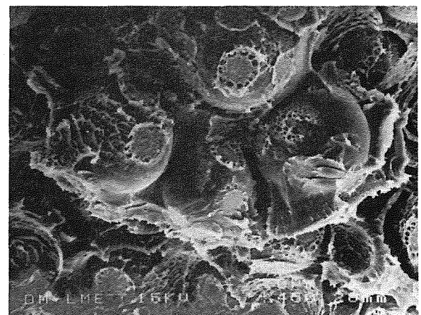
Fig.6. Superficie de fractura de una muestra ensaya a tracción con un contenido de un 80% de HPMA.
