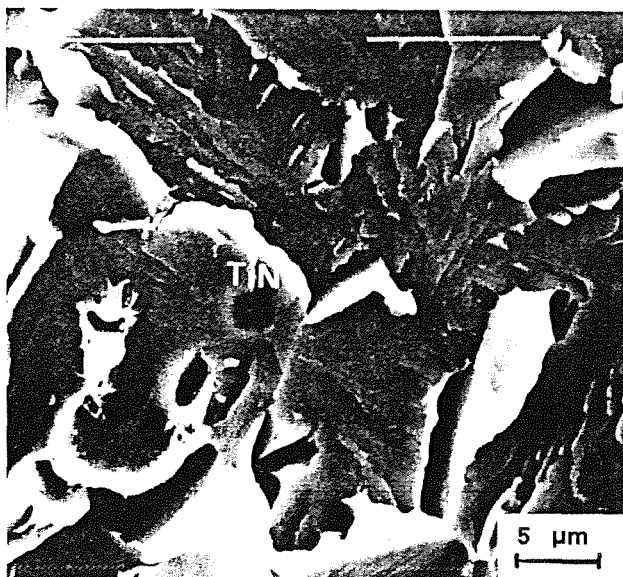
Fig. 4 Inicio de fractura correspondiente a probeta del acero A ( d_{entalla} = 374 \mu\text{m} )
