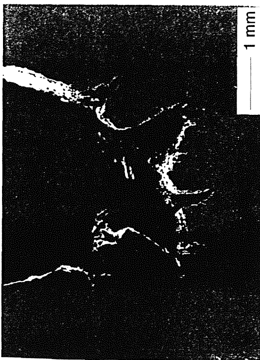
Fig. 6. Perfil del frente de grieta después del colapso plástico con carga de hidrógeno ( COD' = 1 \mu\text{m}/\text{min} ).
