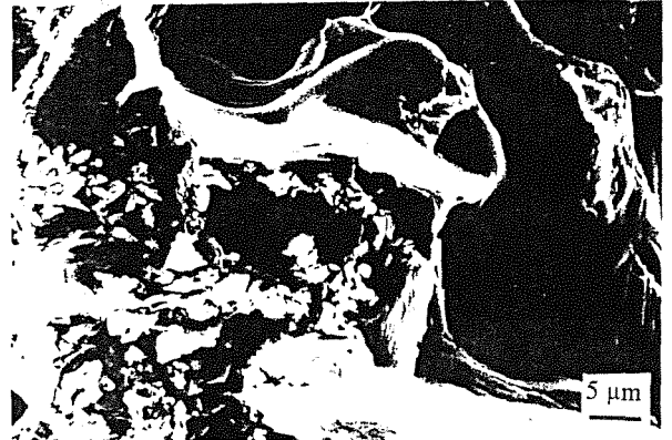
Fig. 9. Detalle de la superficie de fractura de un cordón en material compuesto. Rotura interfacial.
