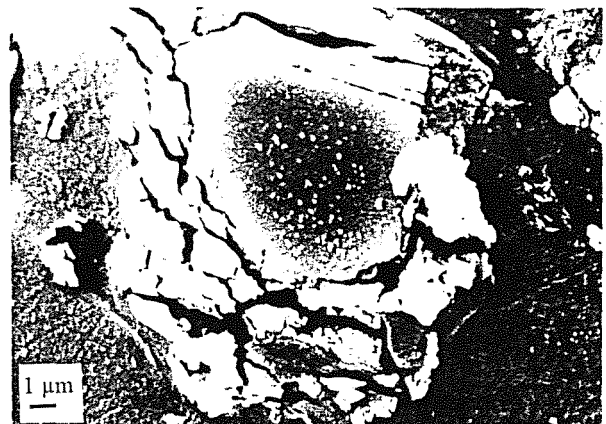
Fig. 10. Progresión de la grieta a través de la interfase generada por reacción entre el SiC y la matriz de aluminio.
