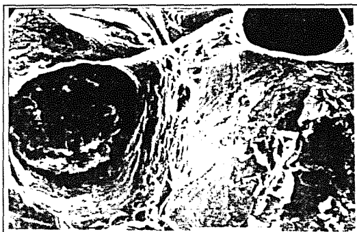
Fig. 3b: Nódulos de grafito (izquierda de la figura) y huecos (derecha). deformación de la matriz alrededor del nódulo, con formación de serpentinillas de deslizamiento. Microcúpulas y superficies de corte de grano de ferrita, sin relieve aparente. (X3000).
