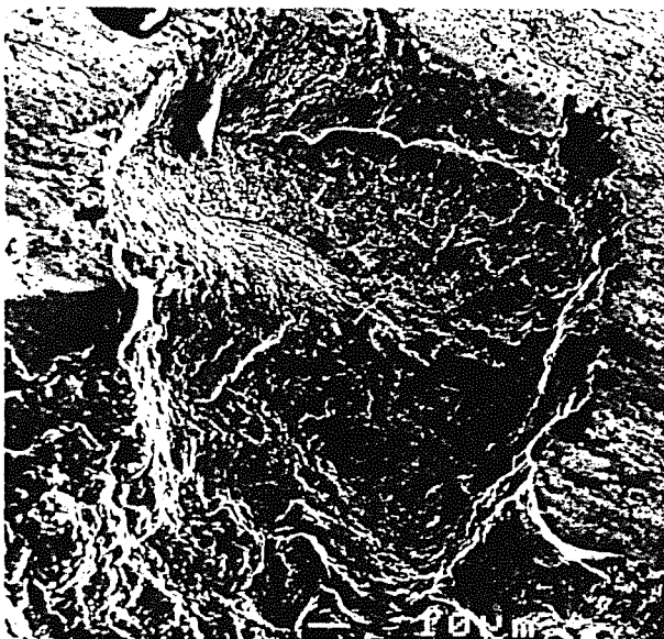
Fig.5. Detalle de una de las picaduras de la figura anterior con marcas concoidales de fatiga.
