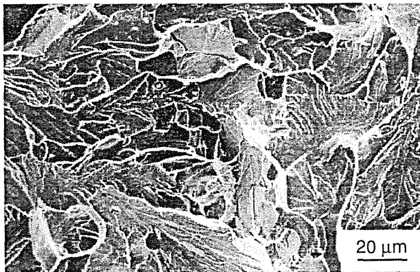
Fig. 4. Zona de la superficie de fractura con morfología de rotura por clivaje.
