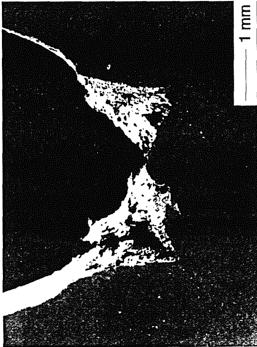
Fig. 5. Perfil del frente de grieta después del colapso plástico con carga de hidrógeno ( COD' = 10 \mu\text{m}/\text{min} ).
