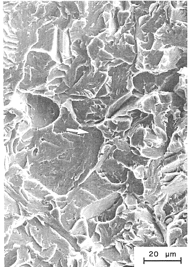
Figura 2. Fractura de martensita. (distancia entalla=184 \mu\text{m} )
