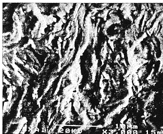
Fig. 10. Fractografía de fatiga del acero B2 (x3000), con \Delta K/K_{IC} = 0.39 .
