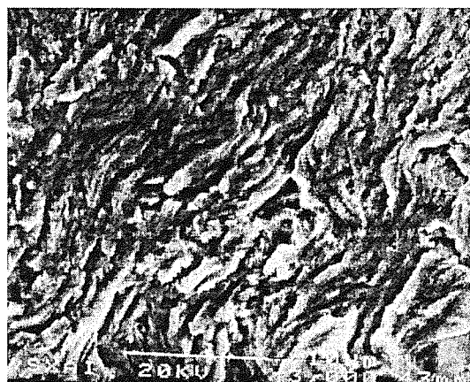
Fig. 9. Fractografía de fatiga del acero B7 (x3000), con \Delta K/K_{IC} = 0.12 .
