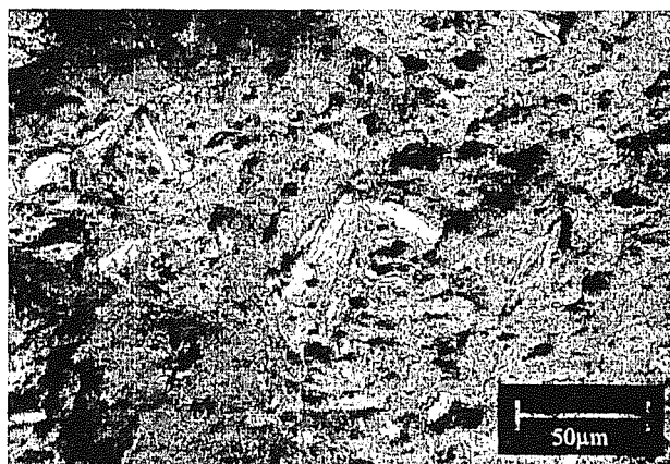
Fig. 5. Fractografía de compactos de polvo Al AM D600.
