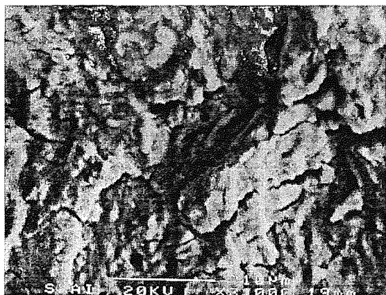
Fig. 11. Fractografía de fatiga del acero B6 (x3000), con \Delta K/K_{IC} = 0.37 .
