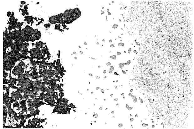
Fig.8. Precipitados globulares en la capa interna de los productos de corrosión (x500).
