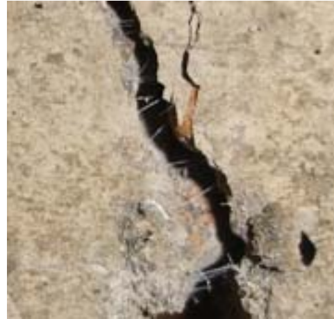
Figura 4.- Efecto de cosido de las fibras de polipropileno en la matriz de hormigón
