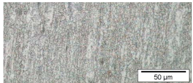
Figura 4. Microestructura en un plano longitudinal del acero E7*.
