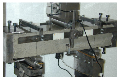
Figura 1: Esquema del montaje del ensayo a flexión en tres puntos.
