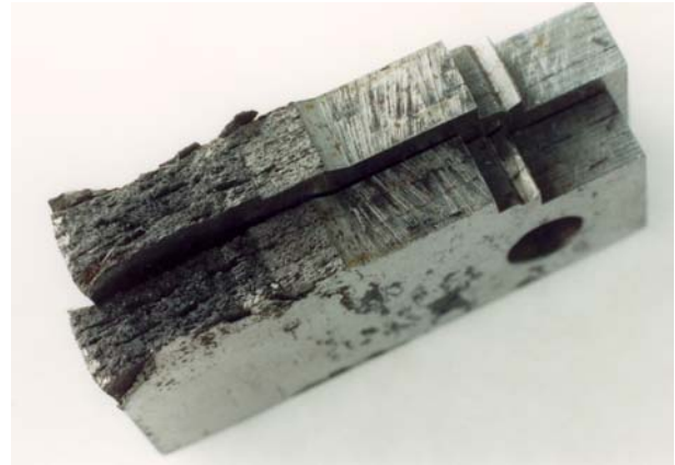
Figura 3.- Superficie de rotura de probetas compactas de hierro pudelado
