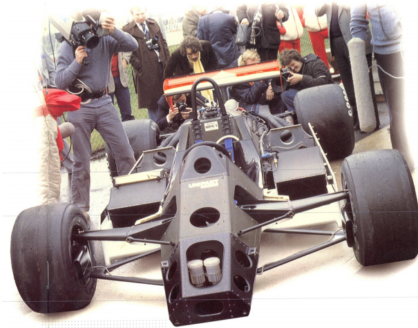
Figure 1. The original composite F1 chassis, McLaren MP4-1
