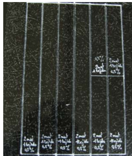
Figura 1. Aspecto final del laminado y marcas de mecanizado
