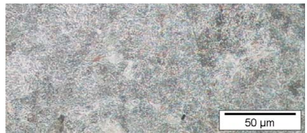
Figura 2. Microestructura en un plano longitudinal del acero E0*.
