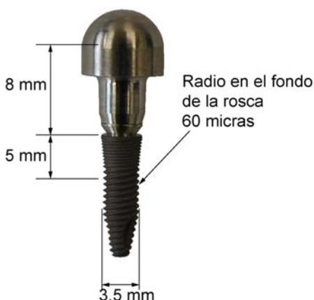
Figura 3. Geometría del implante ensayado.
