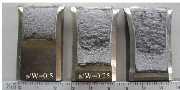
Figura 4. Superficies de fractura de probetas con  $a/W = 0.50, 0.25$  y  $0.10$
