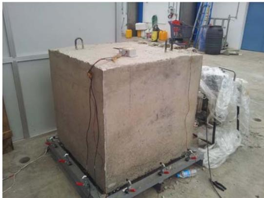
Figura 6. Cubo una vez completado el hormigonado y el desencofrado.
