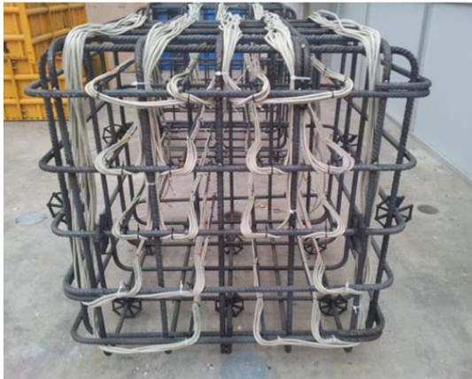
Figura 5. Imagen del cubo previa al hormigonado con los sensores de temperatura colocados en su interior.
