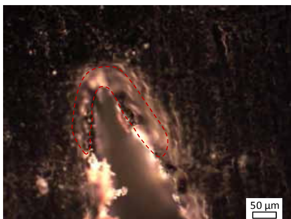
Figura 7. Frente de grieta de una probeta agudizada mediante deslizamiento de cuchilla en la que el daño se ha delimitado con un trazo discontinuo en rojo.
