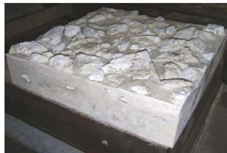
Figura 3. Detalle de la placa balasto
