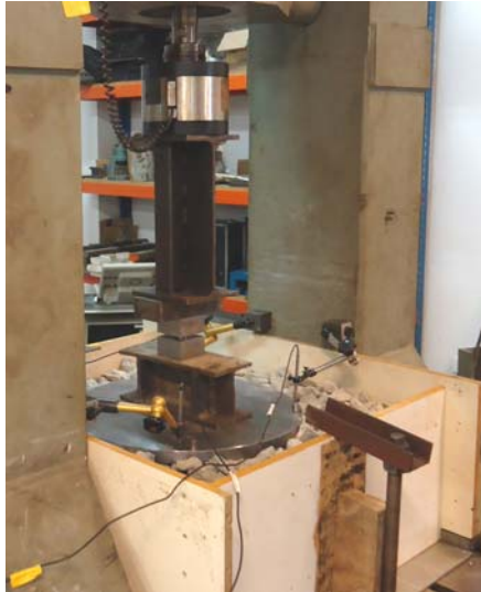
Figura 4. Dispositivo empleado para la fatiga
