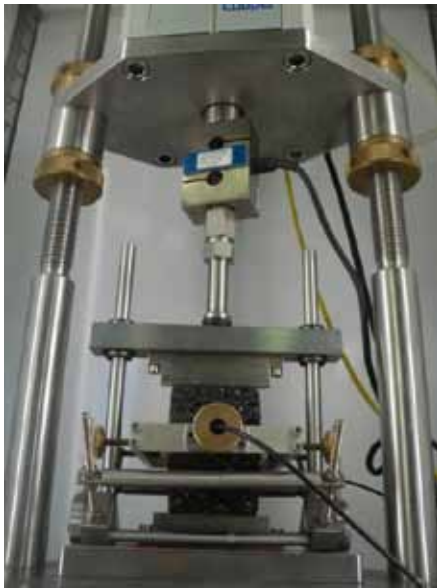
Figura 1. Ensayo de tracción indirecta.
