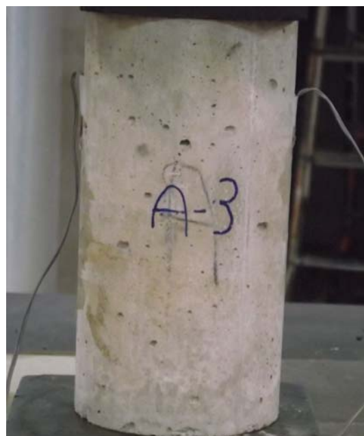
Figura 2. Probeta cilíndrica de hormigón instrumentada autocompactante de alta resistencia.
