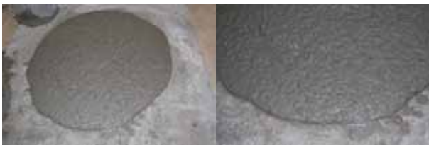
Figura 1. Aspecto visual de la "torta" de la dosificación HAC4,5 tras el Ensayo de escurrimiento.
