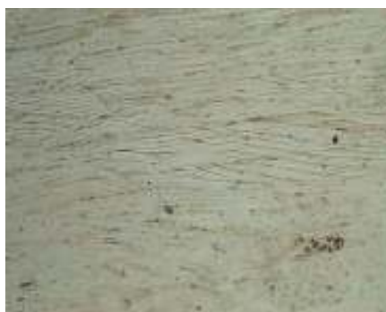
Figura 1. Microestructura del acero 14436 trefilado
