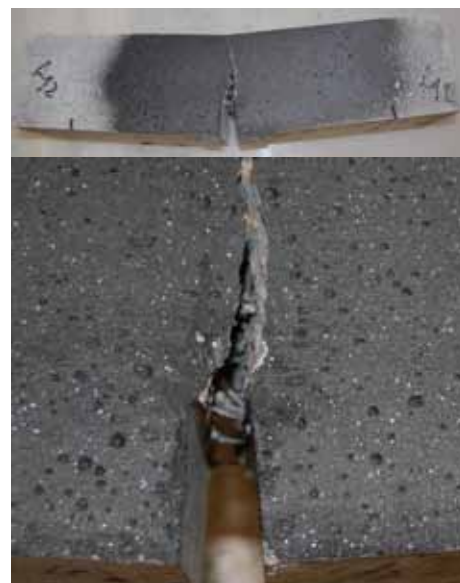
Figura 2. Probeta de HAC4,5 después del ensayo de fractura y efecto de "puenteo" de la fibra.
