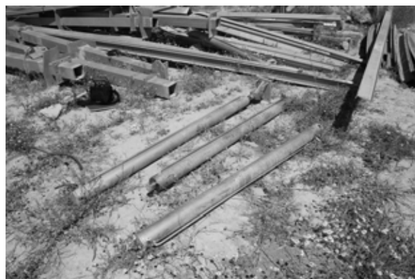
Figura 5. Macrografía de restos de perfiles, guías, y cilindros de los seguidores.
