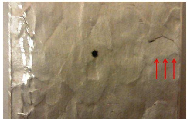
Figura 7: Grieta que se inicia en la zona de reducción de área pero no en el concentrador de tensiones.
