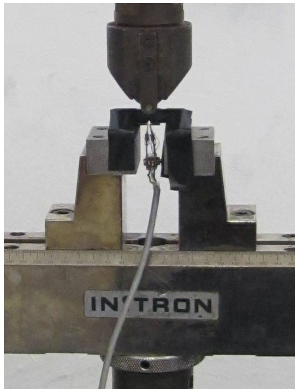
Figura 4. Montaje empleado para realizar los ensayos de K_{IC} mediante flexión en tres puntos.
