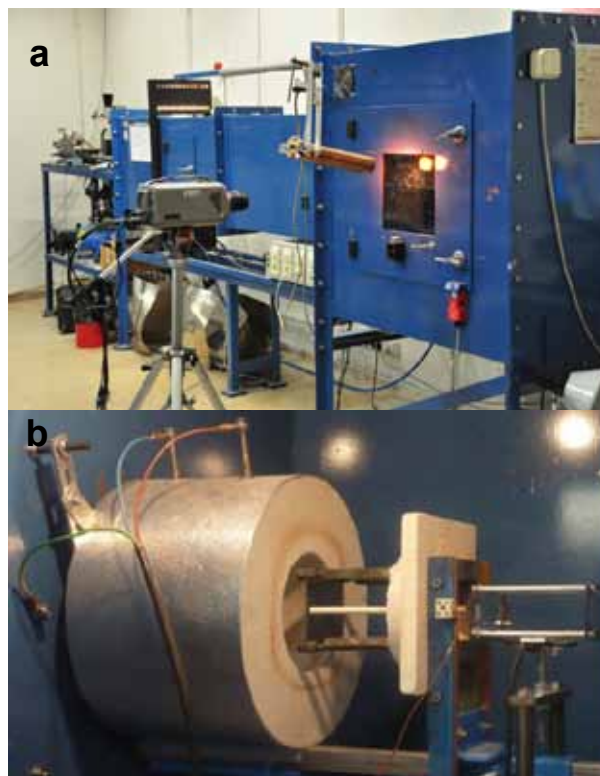
Figura 2. Detalles de los montaje experimentales del cañón de gas para la realización de los ensayos balísticos a (a) temperatura ambiente (25 °C) y (b) alta temperatura (400 °C).
