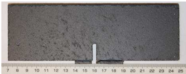
Figura 2. Probeta GRC entallada. Escala en cm.
