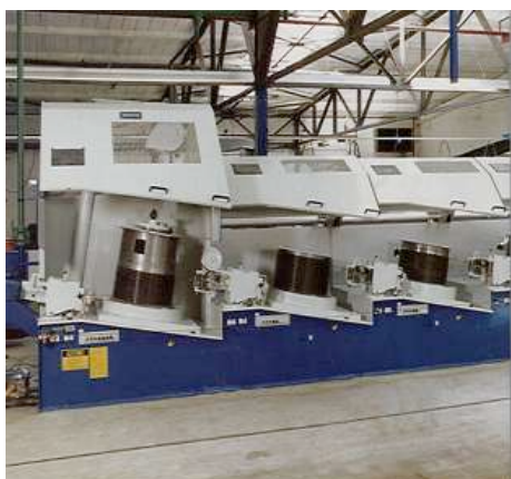
Fig. 1. Fabricación de alambres de pretensado mediante trefilado progresivo de un alambre de acero perlítico.
