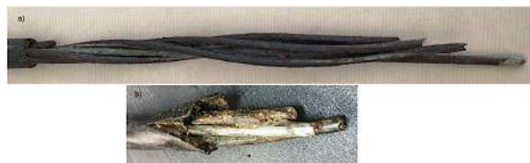
Fig. 2. Ubicación de las roturas de cordones con respecto a la funda de protección en los dos tirantes de retenida rotos
