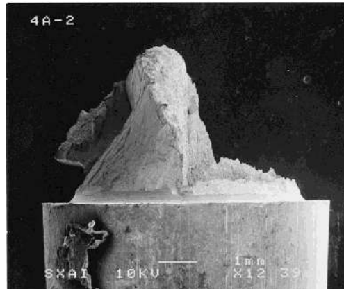
Fig. 5. Perfil de fractura en una muestra entallada de acero perlítico trefilado.
