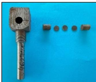
Figura 3. Extracción de las muestras de SPT.
