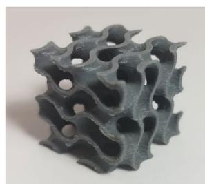
Figura 1. Giroide tipo *sheet* con un 30 % de fracción en volumen utilizado como estructura base.
