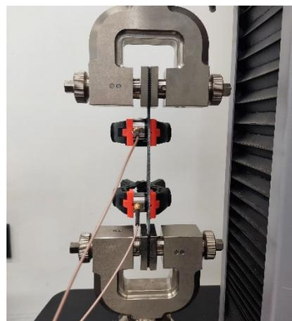
Figura 1. Configuración del ensayo de tracción y sensores de EA.
