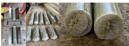
Figura 11: Resistencia a cortante transversal
