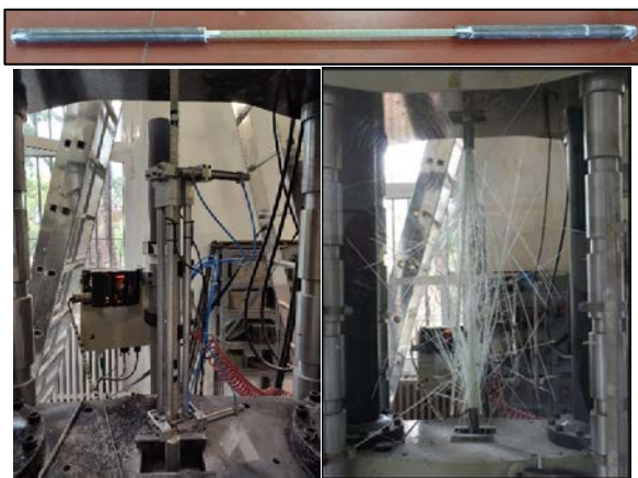
Figura 6. Arriba., Abajo: Izda., ensayo de tracción; Dcha., probeta inmediatamente después de la rotura.
