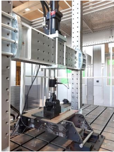
Figura 3. Prototipo de la prensa industrial en bancada de fatiga.
