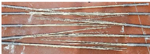
Figura 10 Fractura fibras zunchadas
