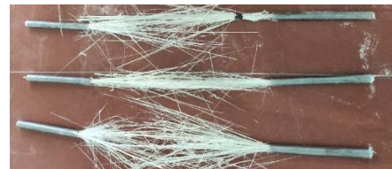
Figura 7. Forma de rotura tipo escoba.
