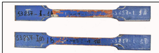
Figura 5. Probetas mecanizadas para ensayo de tracción
