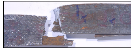
Figura 7. Detalle de la zona de rotura de la probeta A-2T
