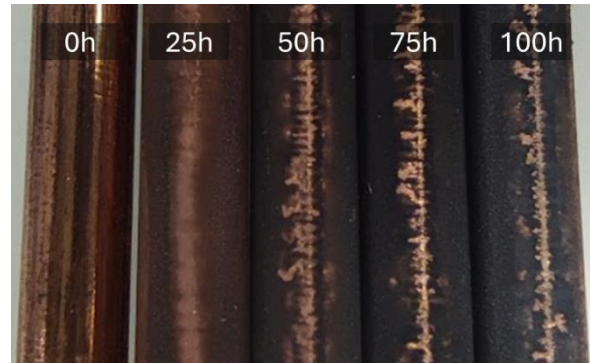
Figura 3. Macrografía mostrando el estado de electrodos sin uso (0h) y tras la exposición a descarga corona (25, 50, 75 y 100h).
