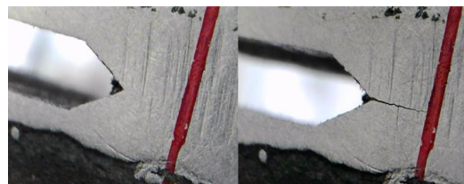
Figura 4. Probeta CT sin y con pre-grieta.
